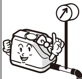
●使用圧力範囲外で使用されると、ポンプに負荷がかかり寿命を著しく低下させる原因となります。適正な圧力で運転してください。
