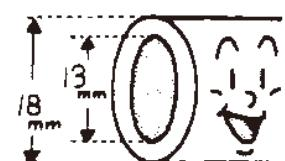
○空気配管は、水道用硬質塩ビ管VP-13（内径13mm・外径18mm）を使用してください。
