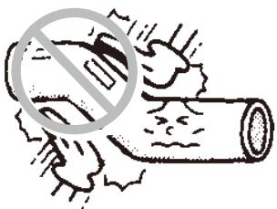
◎L型ホースに無理な力が加わらない様ポンプの吐出口と空気配管の位置を調整してください。
