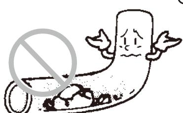
◎配管径を小さくしたり、配管の長さを長くしたり、配管内に異物を残したりするとポンプに余分な圧力が加わりますので、ポンプの温度が異常に高くなりダイヤフラムの寿命を短くすることがあります。
