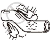
○ポンプと空気配管は、付属の異径型直管ホースで接続しホースバンドで確実に止めてください。
