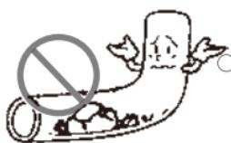
○工事中または工事配管内に土砂等が残らないよう注意してください。
